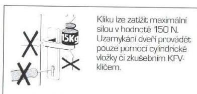
Kliku lze zatížit maximální silou v hodnotě 150 N. Uzamykání dveří provádět pouze pomocí cylindrické vložky či zkusebním KFV-klíčem.
