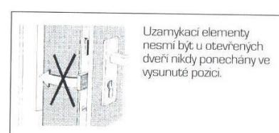
Uzamykací elementy nesmí být u otevřených dveří nikdy ponechány ve vysunuté pozici.
